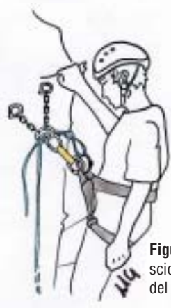
Figura 3: collegamento dell'asola all'anello di servizio dell'imbraco mediante moschettone a ghiera
